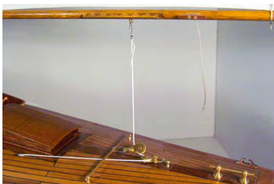
Montage des treuils de voiles avant
